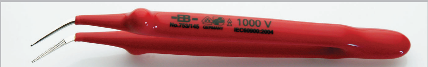
VDE Stahl vernickelt mit VDE Beschichtung nach DIN EN 60900, stückgeprüft, Spitze hochglänzend, PVC Beschichtung rot steel nickelplated with VDE-specification by DIN EN 60900, unit tested, points high polished, PVC coated red
