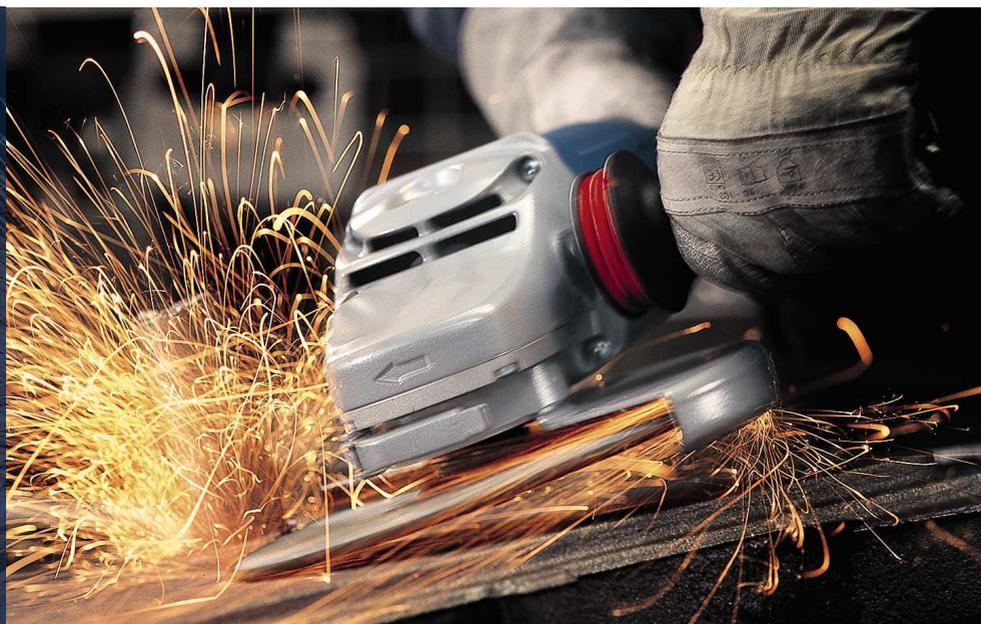
Угловые шлифмашины Bosch с мощностью до 2600 Вт – инструменты высшего класса – рассчитаны на максимальную производительность даже в самых жестких условиях эксплуатации. Их мощные двигатели «Чемпион» благодаря бронированной обмотке имеют особенно долгий срок службы.
